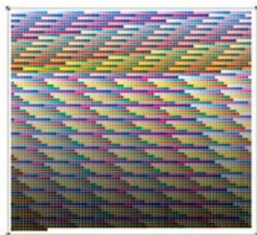
Le piastrelle decorate con queste immagini "Target" vengono acquisite tramite lo Scanner Iperspettrale ISI ed elaborate con il software che in modo automatico calcola il modello matematico del processo e lo concretizza in un file descrittore detto **palette**.
