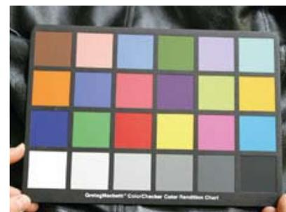
Fig. 5 - ColorChecker, un target per caratterizzare la fotocamera digitale, composto da 24 tacche, di cui le 6 in basso formano una scala di grigi.
